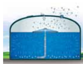
Op zonne-energie werkende mixers uit de SolarBee SB serie en luchtaangedreven mixers uit de GridBee AP serie
